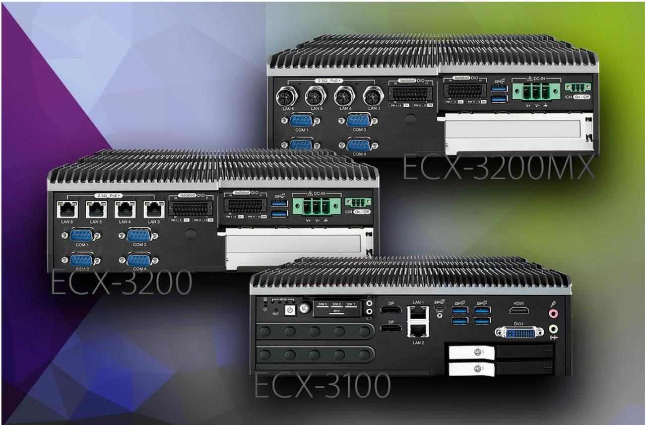
Alling, März 2023 • **Von Industrieanwendungen bis zu Schienenfahrzeugen: Die vielseitigen Embedded Workstations der ECX-3200/3100-Serie von Vecow wurden für höchste Anforderungen an Robustheit und Rechenleistung entwickelt. Sie sind mit den neuesten Intel-Prozessoren der 13./12. Generation (Raptor Lake-S/Alder Lake-S) mit Intel R680E Chipsatz ausgestattet und umfassend erweiterbar. Die kompakten, vielseitigen und lüfterlosen PCs sind ab sofort bei PLUG-IN Electronic erhältlich.**
