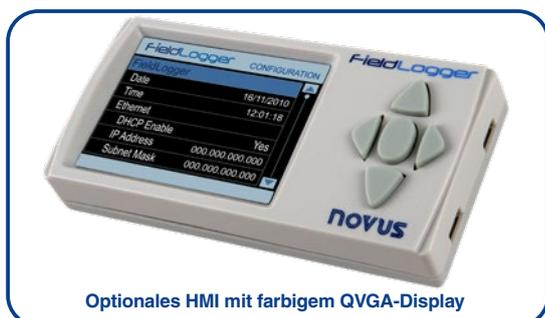
Optionales HMI mit farbigem QVGA-Display
