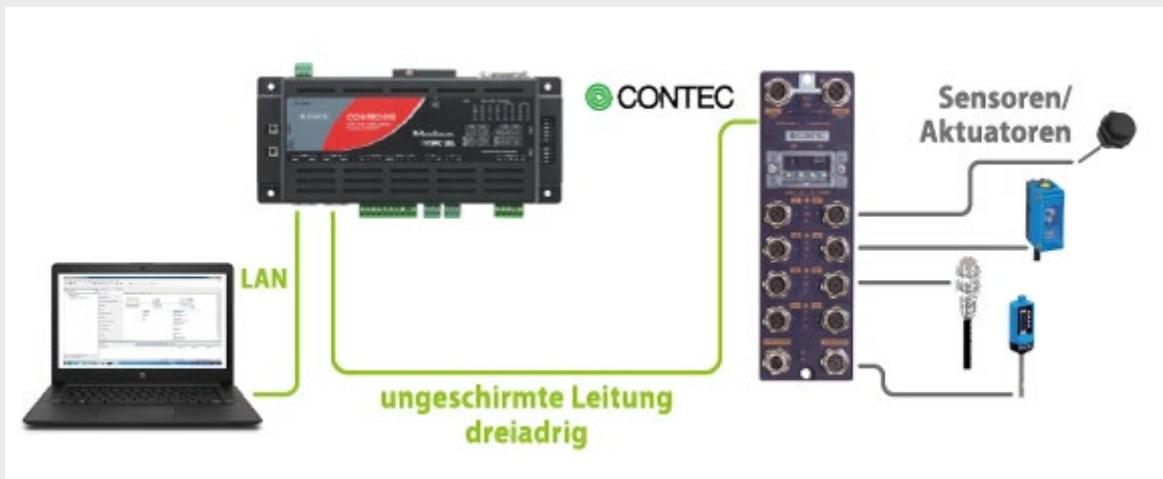
Über eine ungeschirmte, dreidrig Standardleitung (max. 20 m) erfolgt eine störereichere Kommunikation zwischen dem IO-Link Master und dem Device (Slave).
