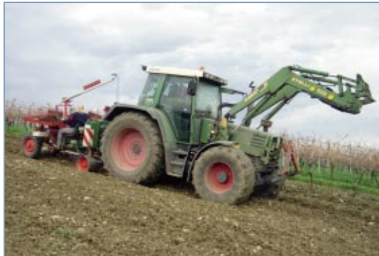
GPS-gestützte Pflanzmaschine mit PICE-3100 im Einsatz auf einer Plantage in Deutschland
